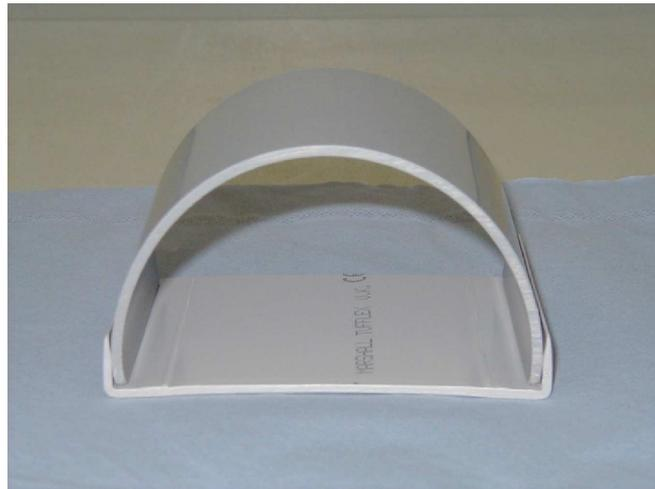
La base se diseña para contener los huevos que no se adhieran a la superficie de la teja y que, por lo tanto, caigan al fondo del recipiente (o los huevos que directamente se coloquen en la base de plástico plana). Todos los sustratos de desove deben lixiviarse durante 12 horas como mínimo, con agua de dilución, antes de usarse.
