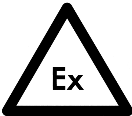
Zona con riesgo de atmósferas explosivas
