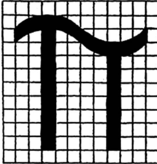
2. La altura mínima del marcado Π será de 5 mm. Para los equipos a presión transportables con un diámetro igual o inferior a 140 mm la altura mínima será de 2,5 mm.
