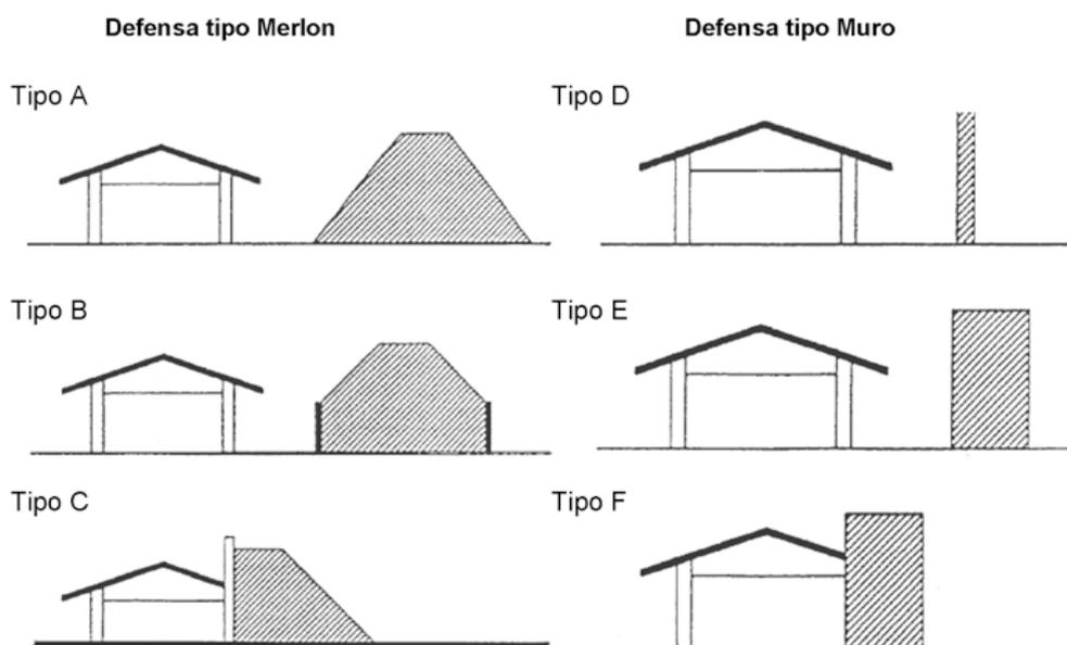
Los muros deben estar calculados para resistir, sin vuelco, el efecto de la onda de choque.
