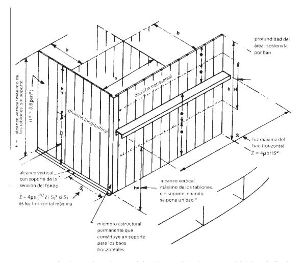
Nota: Si no se instalan palmejares, el espesor de los tableros verticales de madera vendrá dado por la fórmula  $t^2 = 3,6.\rho.b.h^2$ . Al instalarse palmejares, la luz máxima toma el valor  $h_r$ , por lo que el espesor de la madera vendrá dado por:
