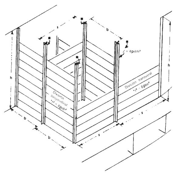
Nota: Cuando los mamparos divisorios longitudinales y transversales sean intercambiables b = s, y los espesores serán iguales empleando ambas fórmulas. Si las arcadas deben ser de igual espesor y diferente luz, el mayor espesor deberá ser usado para todas arcadas, si el módulo resistente es el mismo para todos los puntales.
