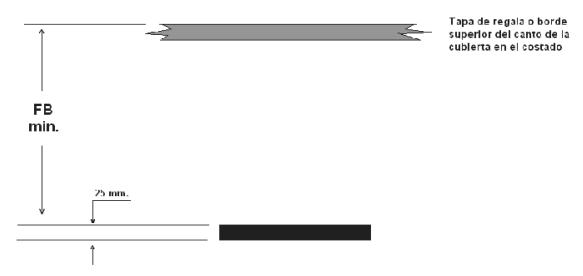
Esta marca se grabará asimismo en ambos costados de las embarcaciones con cubierta parcial o sin cubierta.
