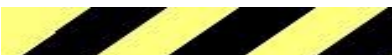
Figura J.8 Balizamiento de obstáculos, en paramentos verticales, de acero, continuo, barrado
