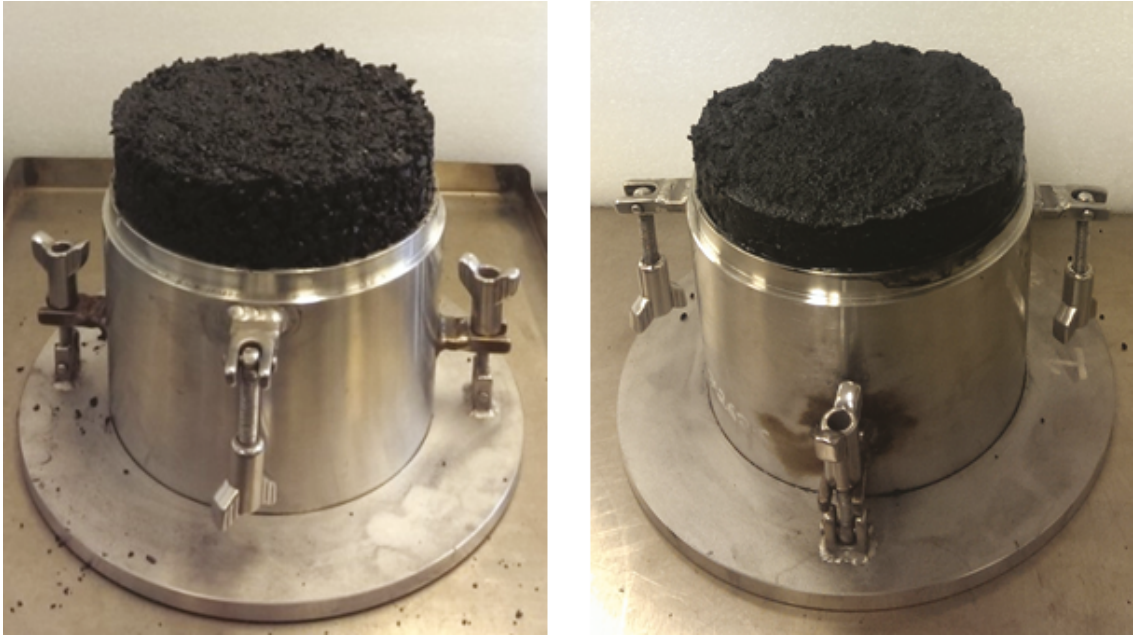
Figura 1.5.5.3.4.1: Fotografías en las que se muestran ensayos válidos con una porción de ensayo parcialmente saturada (izquierda) y una porción de ensayo saturada casi en su totalidad (derecha)
