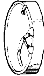
Fig. 31 Detalle del cierre con mecanismo de palanca, visto por dentro
