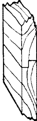
b) Ensambladura por rebajo a media madera
