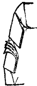
Fig. 84 Fondo conformado, pegado con pasta (Capas superpuestas y ligeramente pegadas entre sí)
