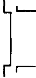
Fig. 2 b) Brides del cuerpo y de un extremo antes de ser unidos por costura
