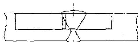
Zona de alteración debida a la soldadura
