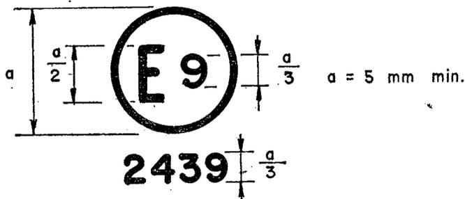
La marca de homologación anterior fijada sobre un dispositivo de alumbrado de la placa posterior de matrícula de un vehículo indica que este dispositivo ha sido homologado en España (E9) con el número 2.439.
