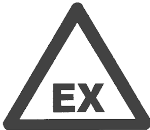
Zona con riesgos de atmósferas explosivas
