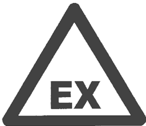
Zona con riesgos de atmósferas explosivas
